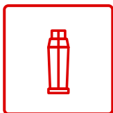
GHS04 Газовый баллон
